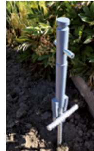
Beispiel für Verwendung des Erdbohrer-Adapters
